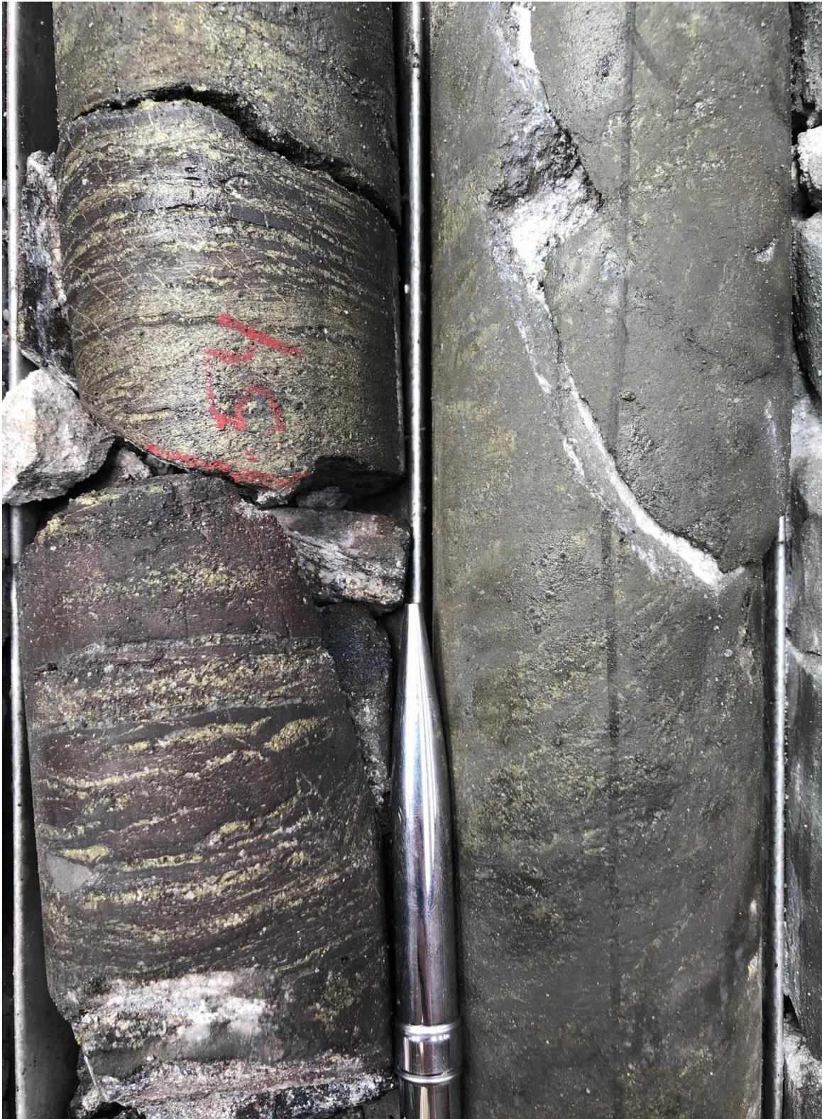
**Figure 5 : Carotte du trou DD1571 à une profondeur de 214 mètres, indiquant de la chalcocite disséminée avec une large veine de cuivre natif coupant dans la zone de brèche.**
