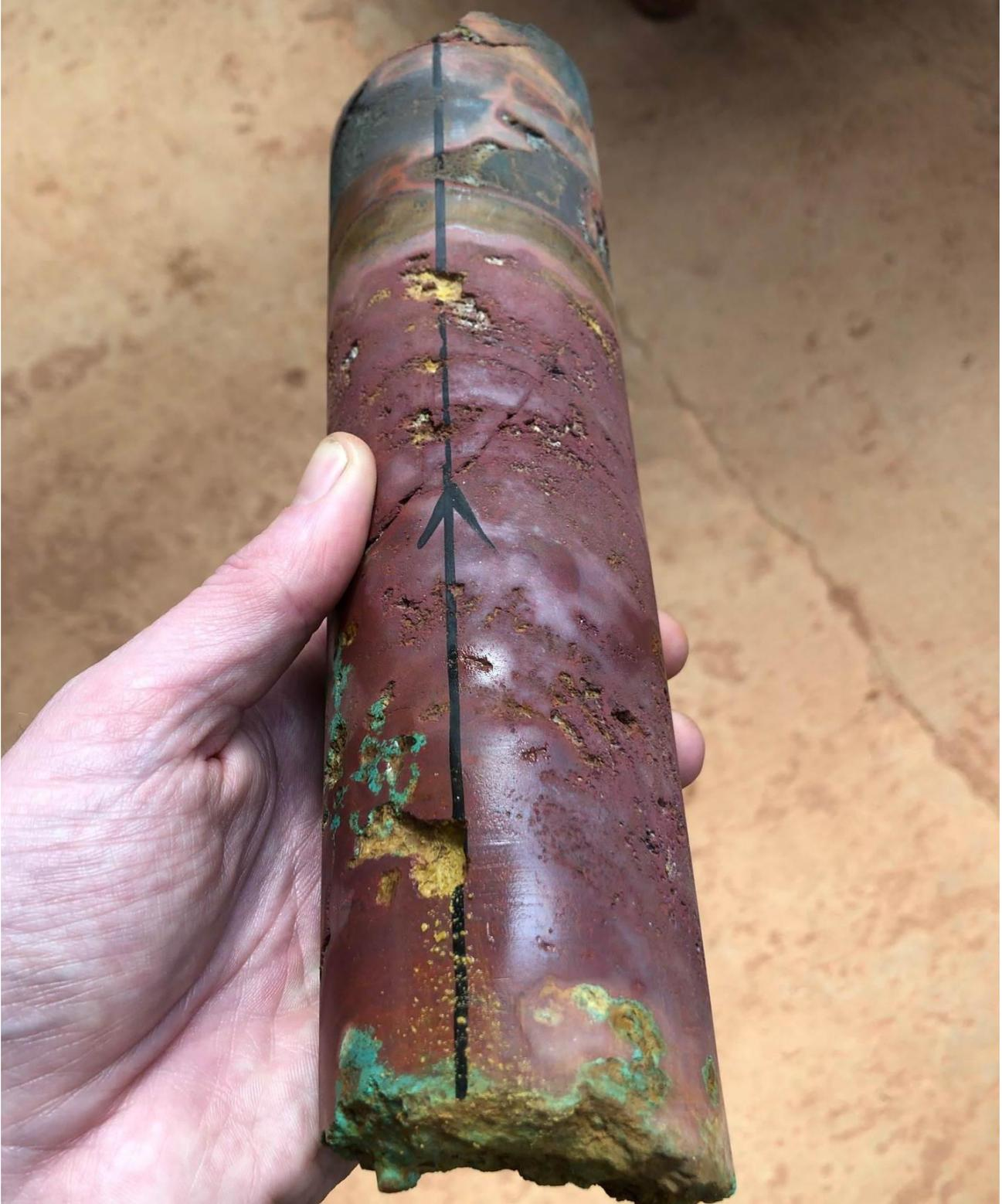
**Figure 4 : Carotte du trou DD1571 à une profondeur de 216 mètres, indiquant de la bornite massive avec des traces de chalcopyrite.**
